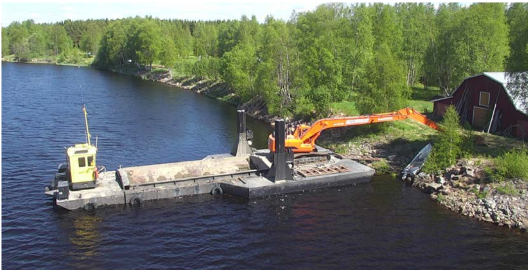
Kuva 1. Kuivajoen siistimisessä käytetty kalusto. Omistaja Antti Ponkala Oy.
